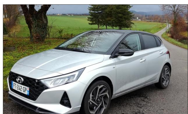
Le tout développe 100 ch transmis aux roues par l'intermédiaire d'une boîte auto 7 rapports ou par une boîte manuelle dite « intelligente » à 6 rapports (iMT). La technologie d'hybridation légère 48 V permet à un moteur électrique d'épauler le moteur traditionnel afin de booster les phases de démarrage et ainsi faire quelques économies de carburant. Lors de notre essai, nous avons apprécié la douceur
