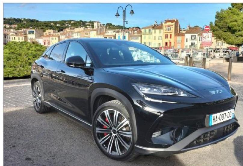
kWh permettant 482 km d'autonomie en mode mixte, Design AWD, 4 roues motrices de 530 ch, avec la même batterie et l'ajout d'un moteur supplémentaire sur l'essieu avant de 217 ch. L'autonomie est ici de 456 km. Enfin, la version Excellence AWD dispose des mêmes attributs, mais emporte une plus grosse batterie, 91,3 kWh, pour permettre 502 km d'autonomie.
